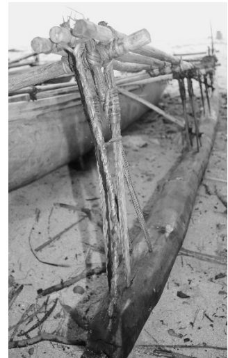
図8-8b キリウィナ島蔦紐によるアウトリガーの結縛
