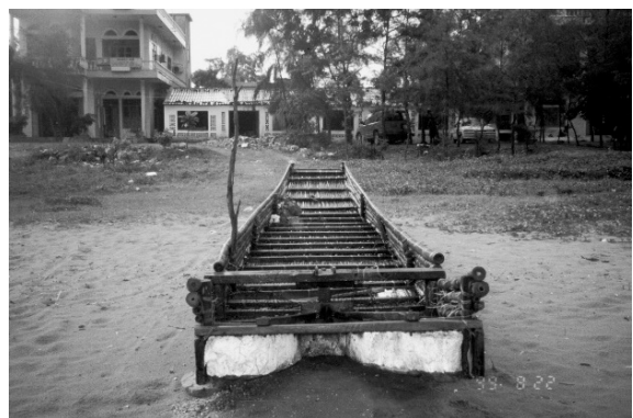
図5-10 ベトナム・モンカイ海岸で使用される竹筏改良型漁船
