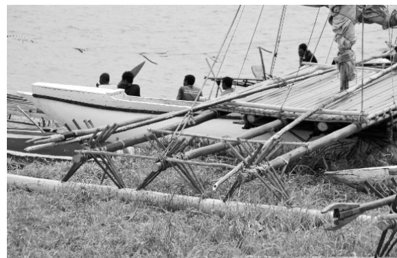
図8-10 籐で結縛されたミルンベイ型カヌー
