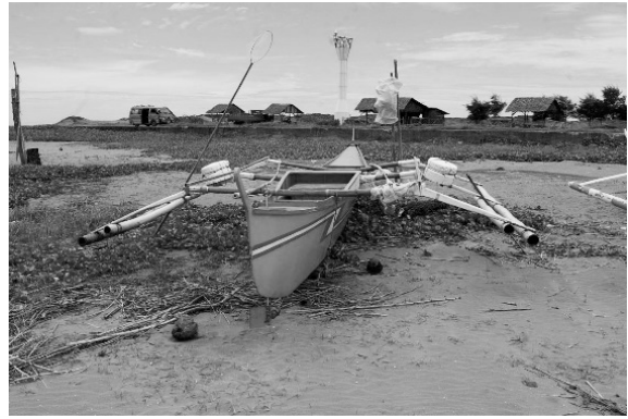
図7-4 間接結合法のダブル・アウトリガー式カヌー： フィリピン・ルソン島・アパリ川河口付近
