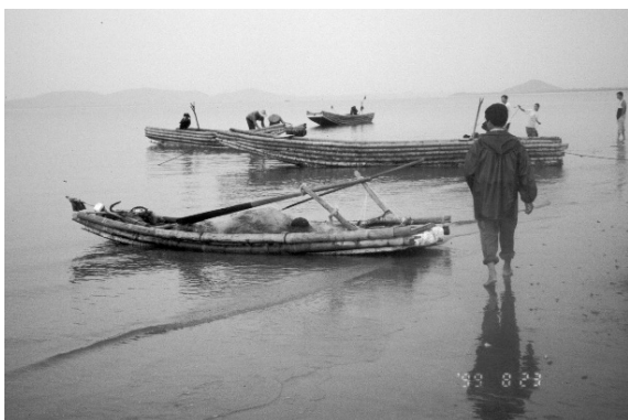
図5-10 ベトナム・モンカイ海岸で使用される竹筏改良型漁船
