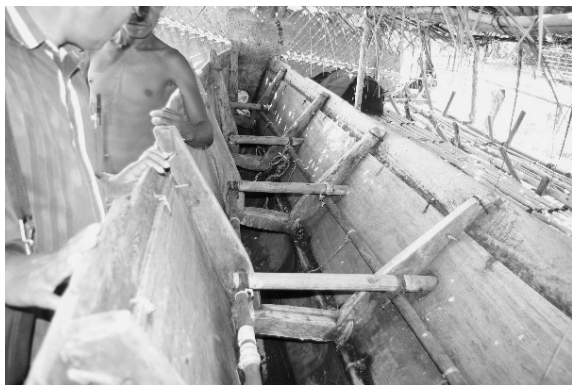
図8-17a クラカヌーの内部構造 (キリウィナ島)
