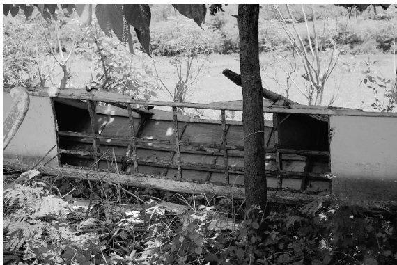
図11-4 バンカの合板製船体の骨組み (Davila)
