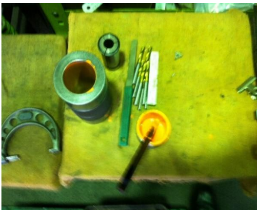
写真 5-19 検査治具と光明丹
