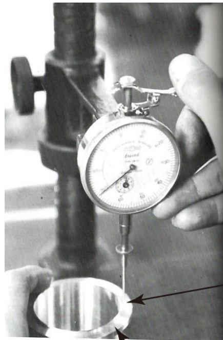
写真 5-8 T 社の作業台においてあるダイヤルゲージ（技能士の友編集部編 1970：112）
