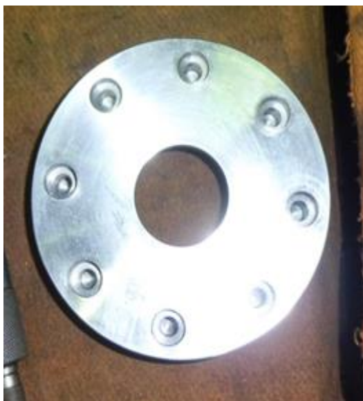
写真 3-1 加工後のクランピングダイ (表側)
