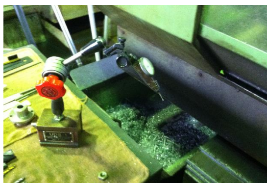
写真 5-2 T 社 H 氏の作業台において あるダイヤルゲージ
