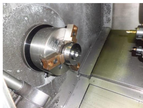
写真 5-13 NC 旋盤に取りつけた爪
