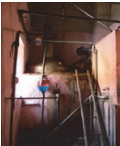
Figura 5: Trapiche hidráulico de tres cilindros (Pacán)
